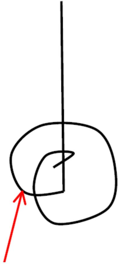
Corte um longo pedaço de arame. Dobre uma extremidade do fio para formar uma espiral horizontal que se encaixa na base da bola de terra.
