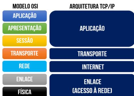
A quantidade e nome das camadas apresentada acima para a Arquitetura TCP/IP foi baseada na documentação oficial (RFC 1122)<sup>2</sup>. No entanto, alguns autores modelam essa arquitetura com três, quatro ou cinco camadas de nomes bastante diversos. Observem que ela condensa as camadas de aplicação, apresentação e sessão na camada de aplicação. Ademais, ela condensa a camada física e de enlace na camada de enlace e chama a camada de rede de internet.
