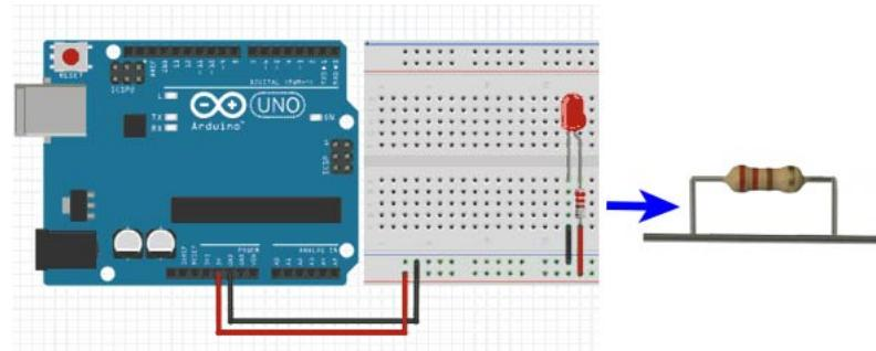
Qual é o erro desse circuito? Pense um pouco sobre o fluxo da corrente elétrica.
