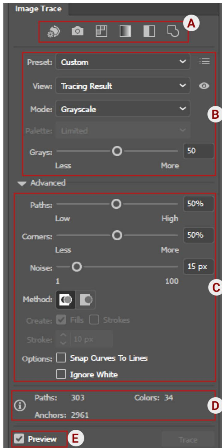
**A** - Ícones que trazem pré-definições de configurações. Ao clicar o software já aplica essas pré-definições;
