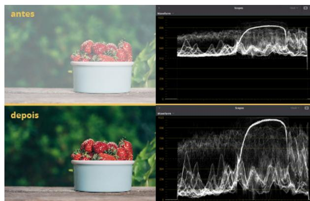
Após os ajustes nos tons escuros e claros, caso os meio-tons precisem ter um pouco mais luminosidade eles podem ser ajustados sem alterar o que já foi feito anteriormente. Para isto deve-se criar um novo nó, e, no menu Primaries, utilizar a ferramenta Gamma.
