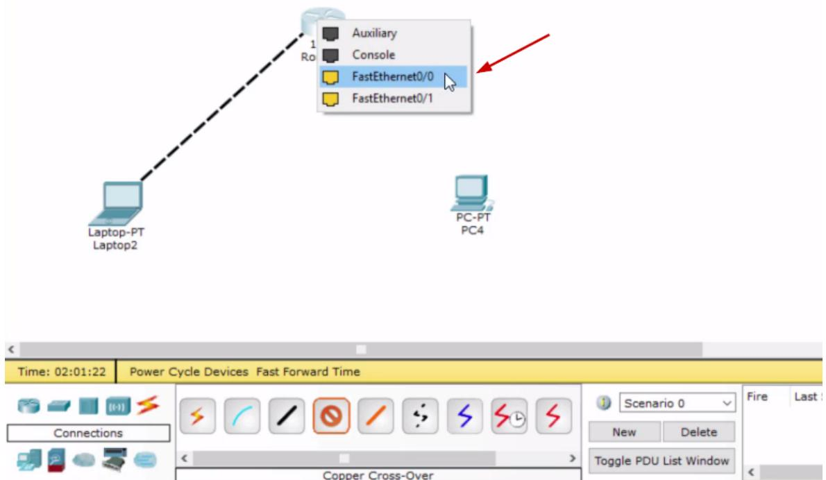
Nós colocamos na porta disponível "FastEthernet0/0". Depois, faremos a conexão entre o computador e o roteador.
