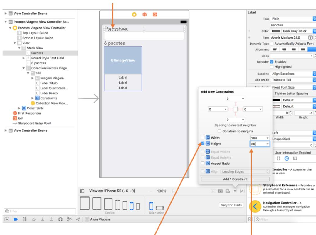
Para arrumar a altura da label de contador de pacotes, vamos setar uma constraint de altura:
