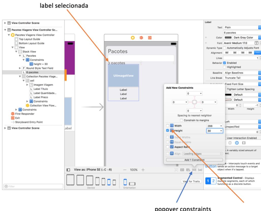
Agora que colocamos uma restrição de altura mínima para as labels, podemos aumentar o espaçamento de todos os elementos de uma só vez, através da propriedade 'Spacing':
