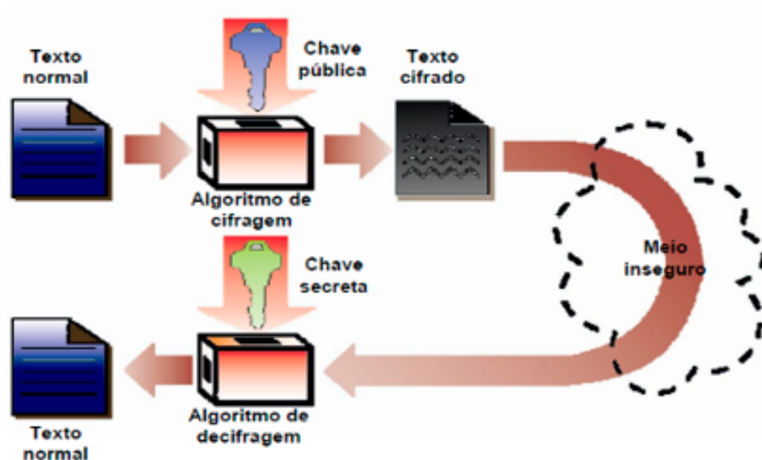
Ilustração de um processo de criptografia por chave pública Fonte: GARFINKEL, Simson; SPAFFORD, Gene (2001, p.208).
