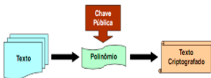
Figura – Criptografia Assimétrica – Encriptar
