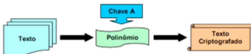
Figura – Criptografia Simétrica – Encriptar
