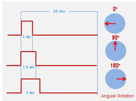
Logo, para cada valor do pulso, entre 1 e 2 milissegundos, o motor ficará em uma angulação diferente. Por exemplo, para posicionar o motor em  $45^\circ$ , mandamos um pulso de 1.25 milissegundos.
