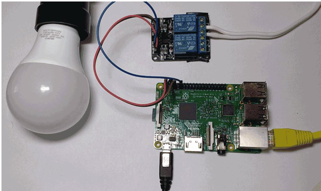
Agora podemos voltar ao nosso servidor web e testar tudo. No **DEVICE 1**, clicando em **ON**, a lâmpada acende, e em **OFF** ela apaga. Assim o controle via web está finalizado, vamos ver agora o aplicativo para smartphone.
