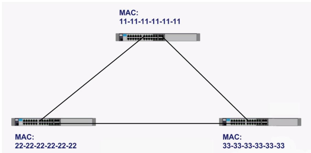
Os *switches* enviarão um protocolo para verificação de existência de algum tipo de *loop* na rede. Este protocolo é chamado de *Bridge protocol data unit(BPDU)*, dentro da qual haverá um campo referente à Prioridade, e outro ao endereço MAC do *switch* que enviou o protocolo originalmente.
