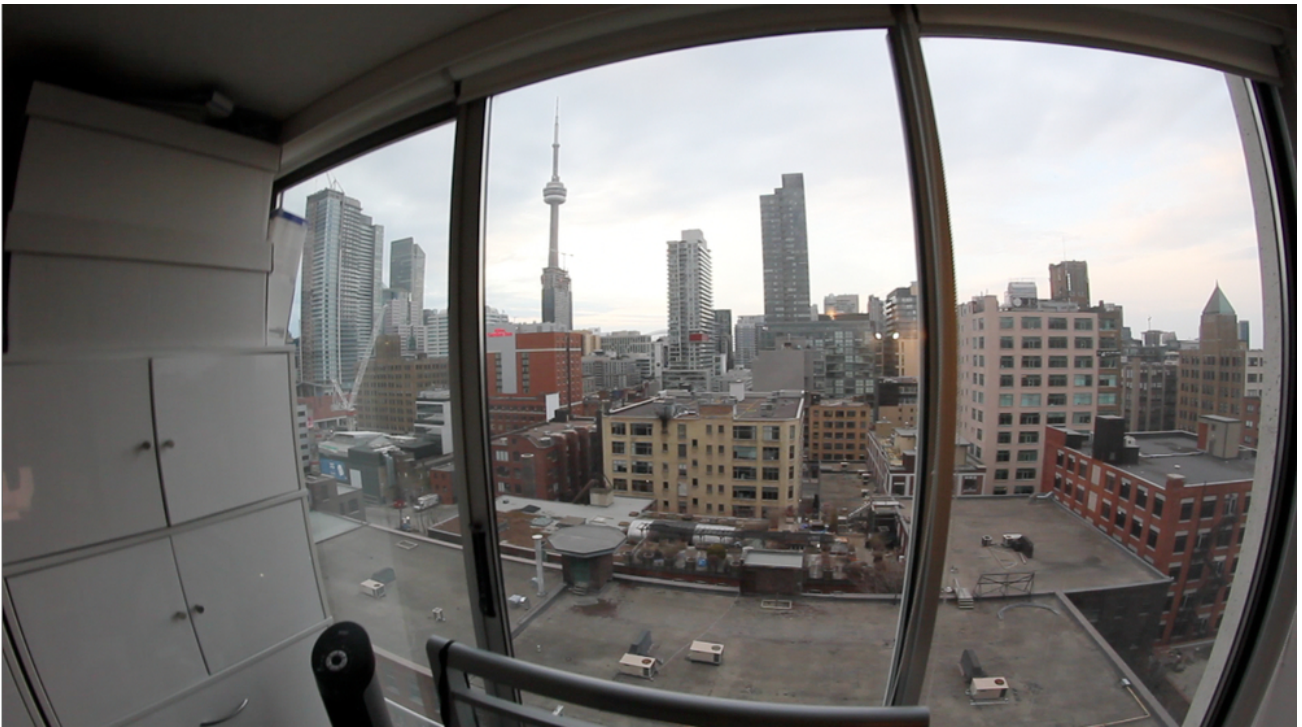
Exemplo de distorção geométrica causada pela lente.
