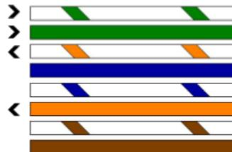
A placa de rede do computador transmite na posição 1 e 2, e recebe na posição 3 e 6.
