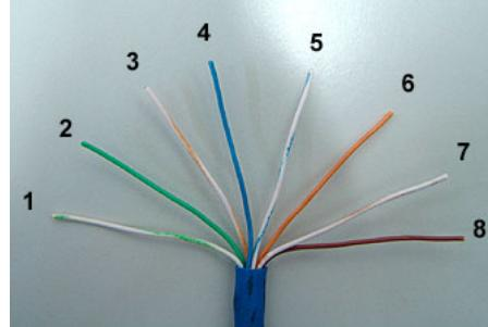
Os fios soltos, são aqueles que estão internamente no cabo e depois, serão inserido no conector plástico chamado RJ45. Este processo de colocar os fios no conector plástico, chamamos de crimpar.
