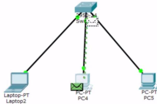
Observe que a informação do ARP para tentar descobrir onde está o laptop foi passada para o Switch, que também não sabe qual computador está conectado. Ele irá enviar as requisições para os outros computadores, com exceção da máquina de onde foi originada a informação.
