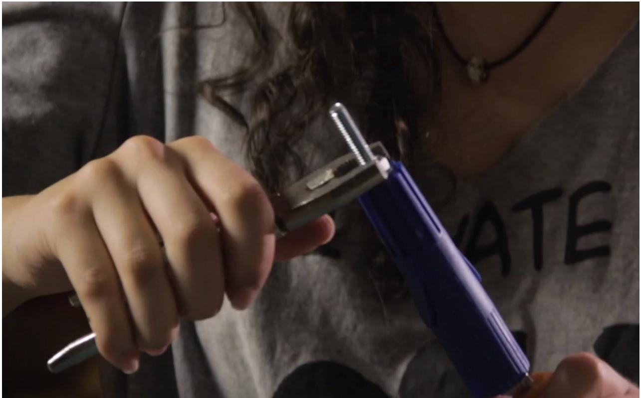
Corte o excesso de parafuso utilizando uma serra ou *dremel*.
