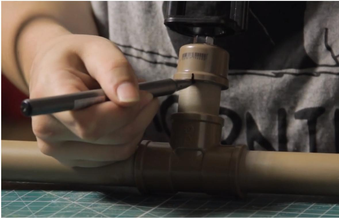
Passe cola na parte interna da tampa e cole-a na estrutura.
