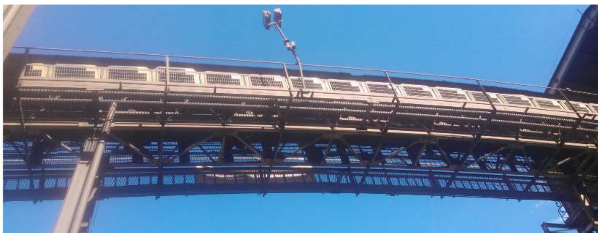
Transportador contínuo suspenso – (Mineração) com passarela para trabalhadores em operações de manutenção e inspeção, e proteção fixa contra acesso na área da correia transportadora
