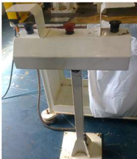
Comando bimanual instalado em pedestal
