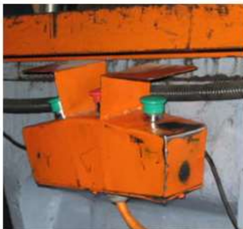
Outro exemplo de comando bimanual e botão de emergência ao centro
