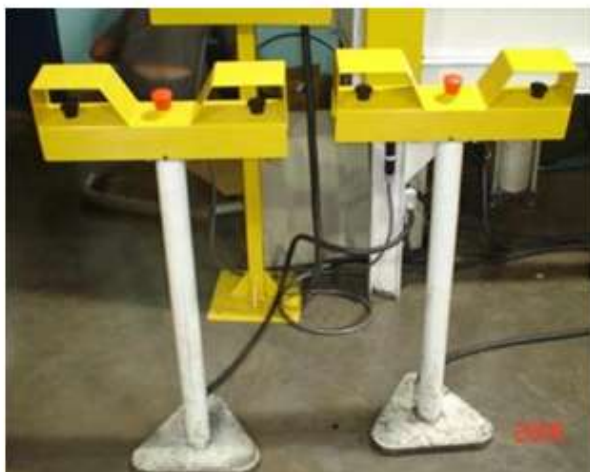
Algumas máquinas são acionadas por dois ou mais comando bimanuais
