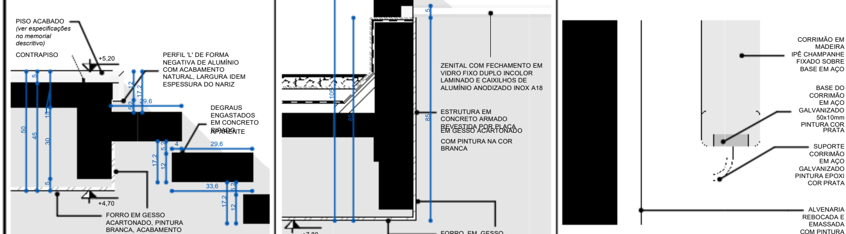
05 ESCADAS - DET. DEGRAUS | ESCALA 1:10
