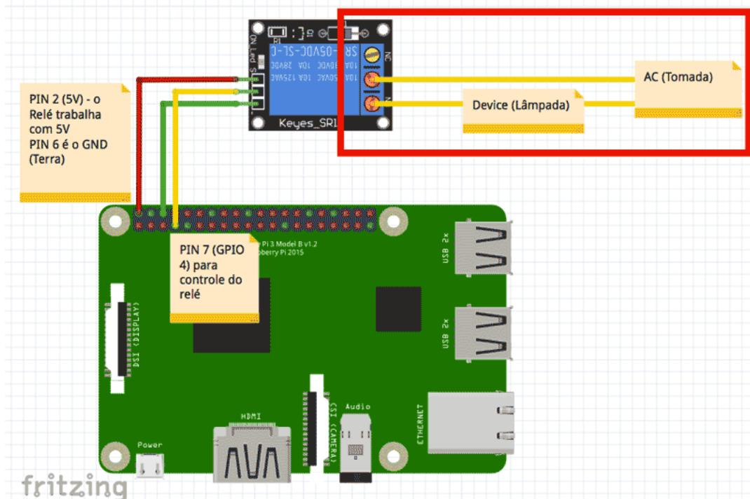
Faça toda montagem sem alimentação do seu Raspberry Pi e sem 110V!
