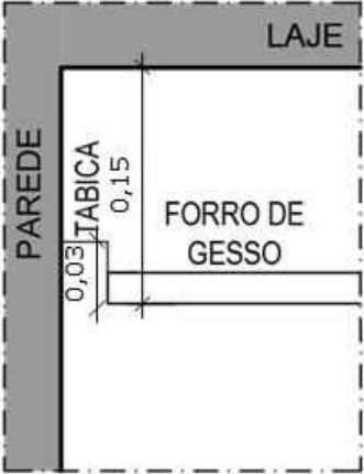
DET. 01 - GERAL TABICA DO GESSO Escala 1:10
