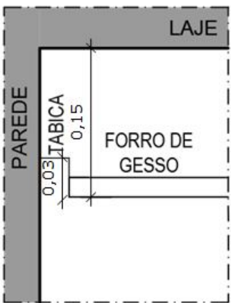
DET. 01 - GERAL TABICA DO GESSO Escala 1:10
