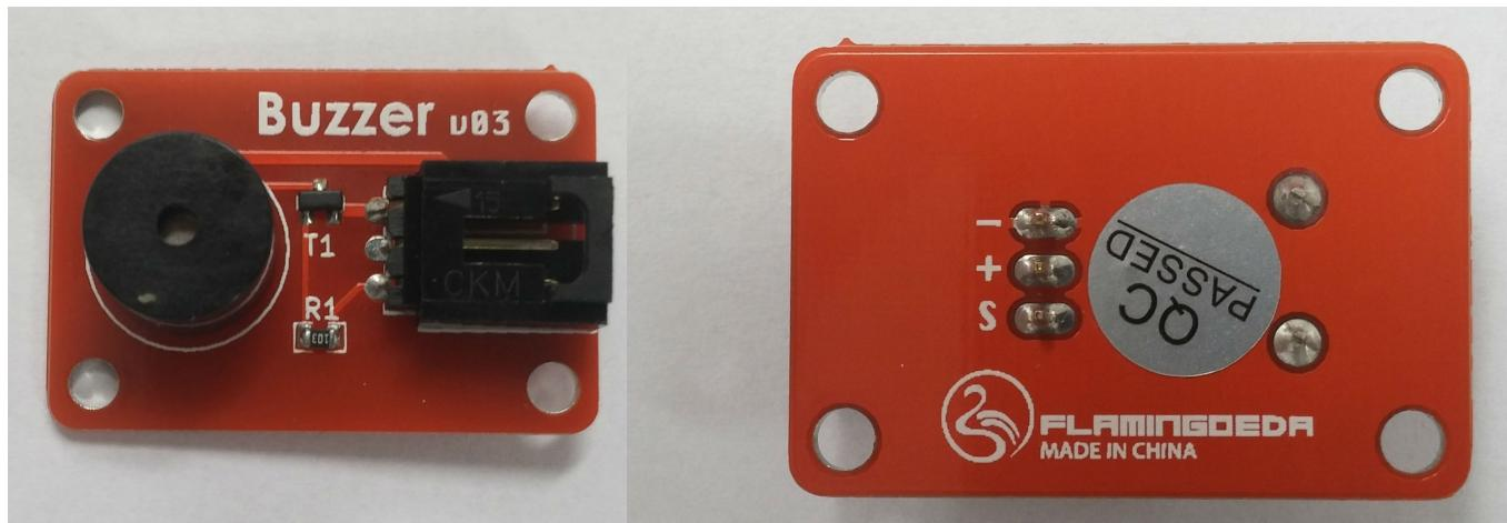
Repare que nele há 3 saídas. A positiva (+) nós iremos conectar no 5 volts, a negativa (-) no terra (GND) e a S ligaremos em uma porta digital, no nosso caso usaremos a 13:
