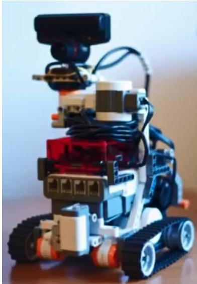
Nesse projeto, foram combinadas várias tecnologias, como a câmera do PlayStation e um motor, tudo montado através do Lego e controlado pelo Raspberry PI. É um carro totalmente autônomo!
