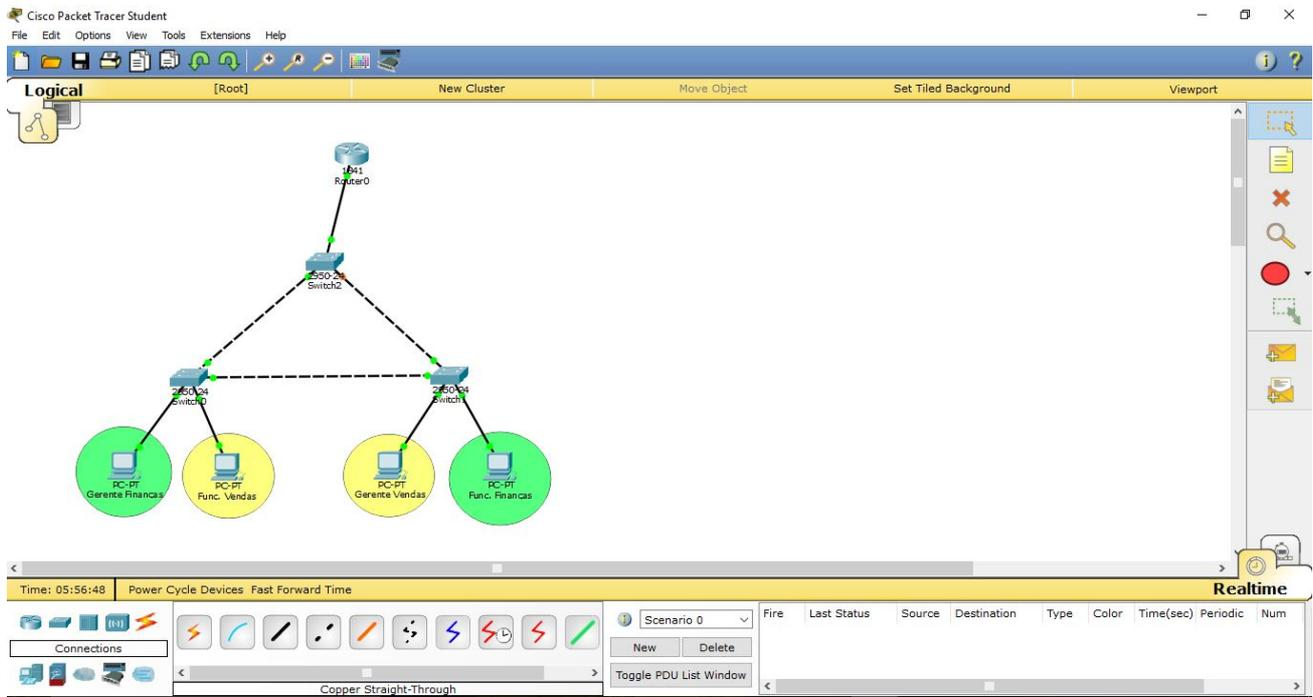
Esse novo Switch deverá transportar dados da Vlan 10 e da Vlan 20, o primeiro passo será criar essas Vlans no novo Switch, uma vez que elas não possuem tais Vlans configuradas.
