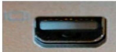
*Figura. Conector mini-display port, em computador Apple.*
