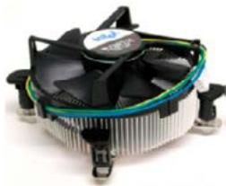
Conjunto de dissipação térmica instalado sobre o processador que é **responsável pela diminuição do calor**.
