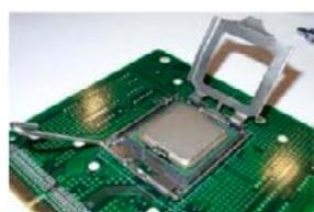
**É o local na placa-mãe em que um processador é encaixado.** Para cada tipo de processador temos um soquete específico.
