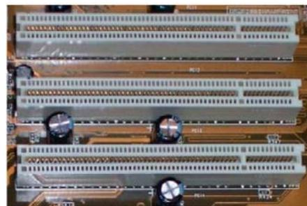
**Desenvolvido pela Intel**, é substituto do ISA, e pode ser utilizado para conectar placas de expansão, como: modem, placa de rede, placa de som, controladoras SCSI, sintonizadoras de TV, digitalizadores de vídeo e afins.
