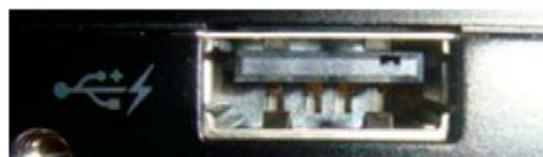
Figura. Conector para eSATA e USB
