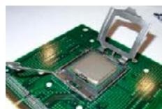
**Soquete** é o local na placa-mãe em que um processador é encaixado. Para cada tipo de processador temos um soquete específico.
