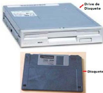
Assim, **o drive é o periférico de entrada e saída e o disquete é um dispositivo de armazenamento** (alguns autores o consideram como periférico de armazenamento!).
