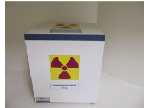
Recipiente blindado para Decaimento do radiofármaco
