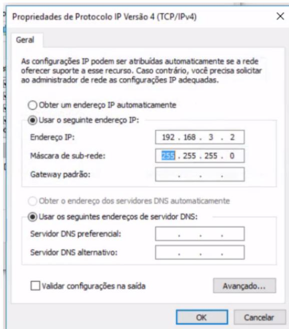
Nós já configuramos com o endereço 192.168.3.2. Lembrando que não podemos ter o mesmo endereçamento IPs para máquinas diferentes. Nesta máquina, meu IP termina com 2 e a terceira máquina terminará com 3.
