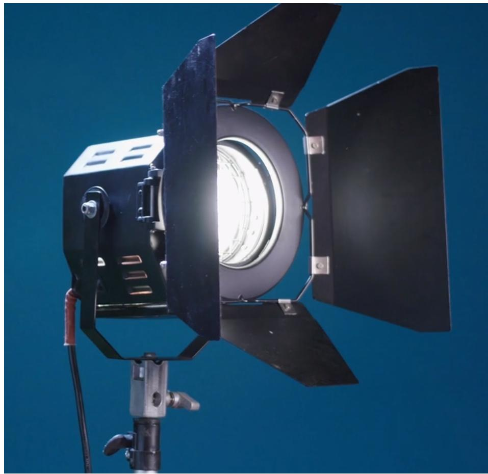
O nome do refletor se deve à lente que possui, graças à ela a luz é direcionada de uma maneira harmônica. Além disso, há como mover a fonte de luminosa que fica dentro do refletor através de um trilho, o que permite abrir e fechar o foco de luz.
