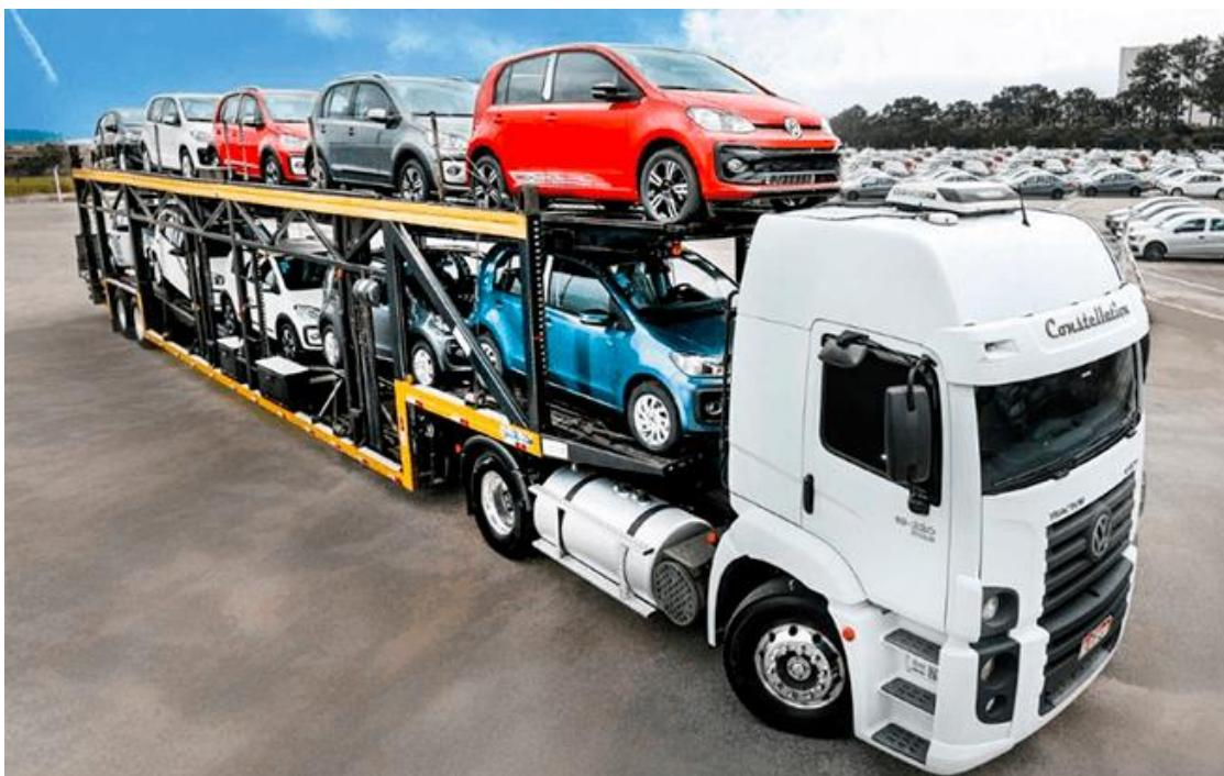
**COMBINAÇÕES DE TRANSPORTE DE VEÍCULOS E CARGAS PALETIZADAS – CTVP** a combinação de veículos concebida e construída especialmente para o transporte de veículos acabados e cargas unitizadas sobre paletes ou racks.
