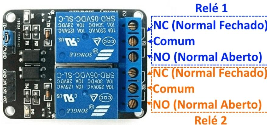
Se o fio estiver ligado ao **NO** (Normalmente aberto) e ao **Comum**, deixando a lâmpada **desligada** até que o Relé seja acionado, e quando isso ocorrer, ele irá fechar e iniciar o contato dos fios. De forma contrária, se o fio estiver ligado ao **Comum** e ao **NC** (Normalmente fechado), deixando a lâmpada **ligada** até que o Relé seja acionado, e quando isso ocorrer, ele irá abrir e interromper o contato dos fios.
