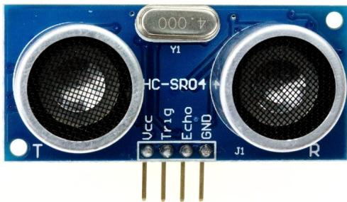
Podemos reparar que o sensor possui 4 pinos, os já conhecidos de alimentação e terra, **VCC** e **GND**, respectivamente, e os pinos **Trigger** e **Echo**. O seu funcionamento é simples, ele emite um pulso, em uma frequência que não é audível aos nossos ouvidos, que bate no objeto e volta, calculando assim a distância percorrida, logo a distância que o objeto está à frente do sensor.
