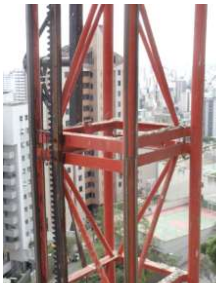
Detalhe da régua dentada (cremalheira) instalada na torre do elevador
