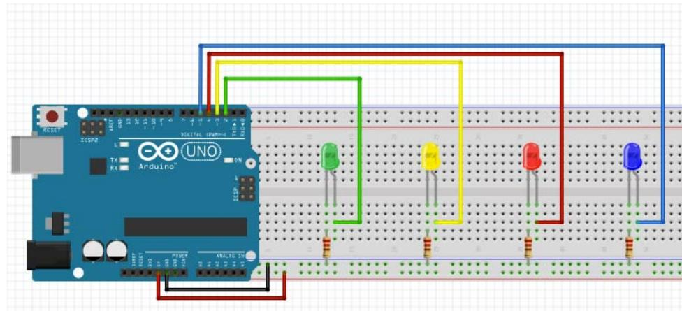
Lembre-se: Proteja os LEDs utilizando um resistor!
