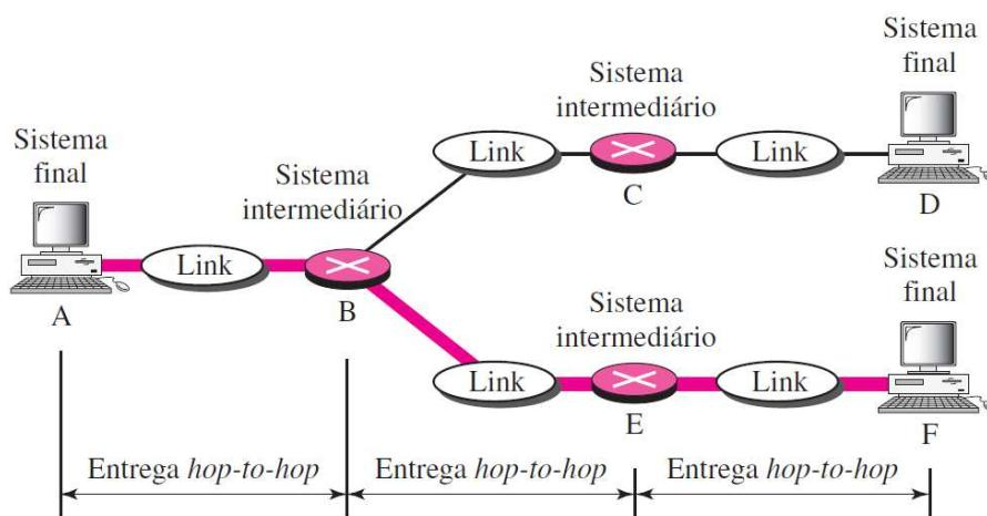
A comunicação na camada de enlace de dados ocorre entre dois nós adjacentes. **Note que, para enviar dados de A a F, são feitas três entregas parciais.** Primeiro, a camada de enlace de dados em A envia um frame para a camada de enlace de dados em B (um roteador). Segundo, a camada de enlace de dados em B envia um novo frame à camada de enlace em E. Finalmente, a camada de enlace em E envia um novo frame à camada de enlace em F.
