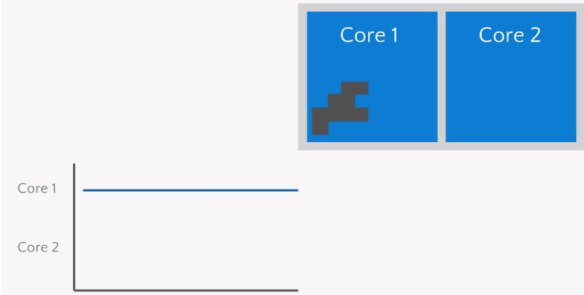
Ao abrir a aplicação, o usuário clica em "Fazer Processamento" e, quando chega ao fim deste, tudo acontece na mesma linha de execução. Não fazemos uso de várias execuções paralelas e, por isso, mesmo usando uma máquina mais potente, o cliente não nota o ganho de performance.
