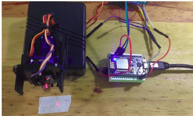
Uma curiosidade que você pode ter é: O *laser* é um dispositivo que funciona com 5 *volt*s e as saídas do NodeMcu operam a 3.3, como ele pode estar funcionando?
