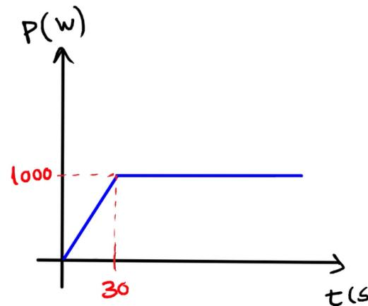
Se Valdisnei pretende aquecer 1L de água de 20°C para 80°C, calcule o tempo que o ebulidor deve ficar em contato com a água, levando em conta que o ebulidor é ligado à tomada já submerso na água.
